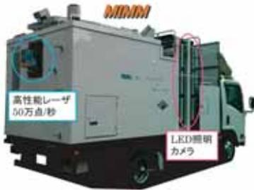
MIMMは、走行しながら連続壁面画像を取得するシステム (MIS) とレーザー計測システム (MMS) を1台に搭載した計測車両で、この技術を活用してトンネル点検や健全性診断を行います。MISにより、ひび割れ、漏水などの変状情報を取得し、またMMSにより変形モード、段差などを検知することで、3Dデータをビジュアル化し、診断や変状原因の推定ができます。ひび割れ検出能は70km/hで0.2mm程度、またレーザーにより0.5mm程度の段差を検出可能で、高精度で客観的なデータベースができ、しかも従来の点検に対し3割程度コスト削減を実現します。(計測検査株式会社、三菱電機株式会社との共同開発)
