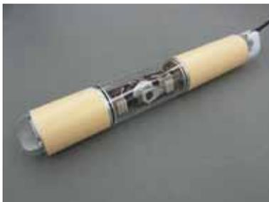
陸上から遠隔操作し管路内を点検する超小型水中ロボット。
