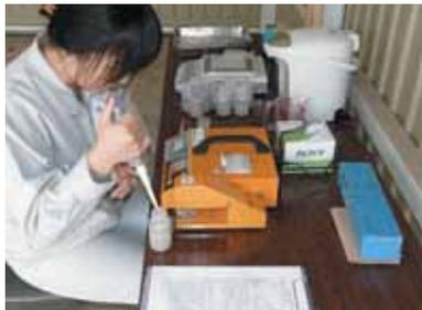
従来、塩害を受けたコンクリート構造物中の塩化物イオン濃度の測定には、コアやドリル粉を用いJIS A 1154やJCI-SC4などの全塩化物イオン濃度が得られる分析法が用いられてきました。これらの分析法は、設備の整った分析機関で実施する必要があるため、結果が得られるまでの期間が長く、費用面でも負担が多くなる傾向にありました。常温の蒸留水や温水を用いて可溶性塩分を測定する方法も提案されていますが全塩分との関係を求める必要があります。本手法は、加熱蒸留水で塩化物イオンを抽出する際に溶出助剤を加えフリーデル氏塩を分解させ全塩化物イオン濃度相当の値が迅速 (15分程度) に得られる分析手法です。
