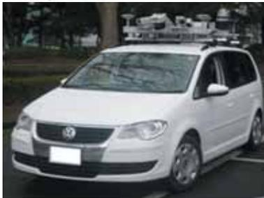
従来の河川台帳や河川縦横断測量による二次元的な管理に対し、測量分野ではすでに活用が進んでいる移動体計測車両を用い、三次元数値データによる堤防評価と河川監視・点検手法も併せた管理の高度化を図るための技術です。
