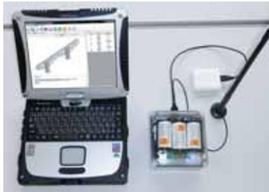
BHELMO (ベルモ) は、無線センサネットワークを用いた橋梁の健全性を診断するシステムです。計測用ノード (ハードウェア) はZigbee方式の通信機能を採用しており、ノード同士での自立組織ネットワークの構築及びマルチホップ通信による広域計測を実現しています。また、3軸方向を同時に計測する加速度センサを搭載しており、上部工、下部工および傾斜の付いた対象物 (PCケーブル等) の計測も可能です。操作画面 (ソフトウェア) はデータ計測の作業手順に沿ったインターフェースを採用しており、作業性の向上を図っています。また、計測データは付属のビューア、フリー変換による固有周期を算出する機能も実装しています。
