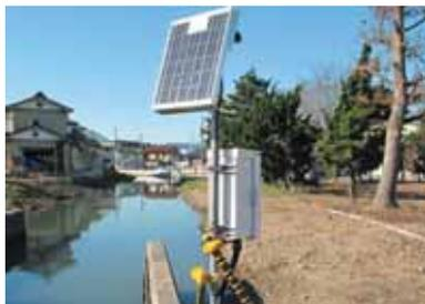
通信装置内蔵水位計を用いて、河川やダム貯水池等の水位をリアルタイムで遠隔監視するシステムです。通信方式は、光コンセント、FOMA通信、インターネット等から選択でき、ソーラー電源で稼働する省電力設計のため、簡易に水系全体を高密度 (多点) にリアルタイムで監視する水位観測網が構築可能です。【観測概要】①3分以内のリアルタイムで水位データを遠隔監視、②15秒の平均水位と振幅を計測、③設定水位による観測インターバルの自動変更可能。【特徴】①通信方式はFOMA通信が標準、他に無線LANや専用光ファイバー等にも対応可能、②電源は、太陽電池による独自電源で駆動、③計測データは、インターネットのWeb画面で閲覧可能 (アクセス認証有り)
