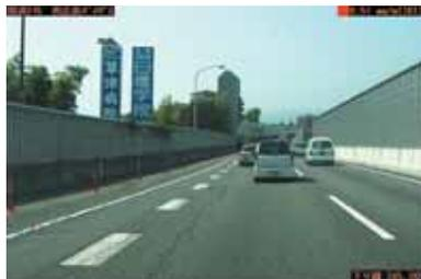
連続静止画を用いた道路管理画像は、日常点検、道路管理台帳の補完、補修区間の状況把握、安全施設等の設置状況及び緊急時の線形確認など多くの場面で広く活用されています。この道路管理画像に“乗り心地”指標であるIRI（国際ラフネス指数）を同時に表示することで路面状況を的確に把握し、適切な路面管理を実現させる手法を目指します。
