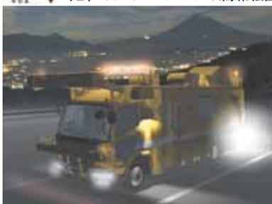
わだち掘れ、ひびわれ、平坦性(σ3m、IRI)の単独評価、あるいは組み合わせの評価のMCなどにより路面の健全性を評価し、舗装改良重点個所の選定を行います。また、IRI算出用路面プロファイルによる段差量の評価や、ひびわれ測定システムによる平面的な損傷・異常箇所の発見も実施できます。キネマティックGPS計測技術により路面の縦横断形状を正確に、スピーディーに計測し、「事故対策」「乗り心地対策」「沿道環境対策」及び「災害予測」に繋がる情報を提供いたします。
